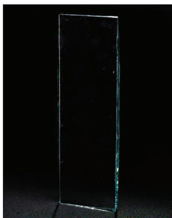
Après l'essai dans la chambre de condensation Cleveland, le verre transparent sans revêtement affichait une brume mesurée inférieure à 1 %.
